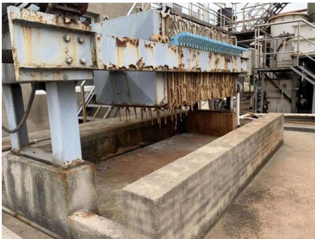
图 4.5-33 污水处理站（压滤机）
